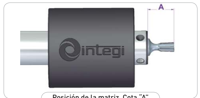
Posición de la matriz. Cota "A" Internal broach position. "A" size
