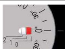
Anzeige in Position 1 / Mittlerer Druck
